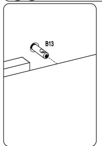
Надвиньте крышку 11 на винты В13 задней стенки Зафиксируйте крышку конусными винтами В14 Установите заглушку кабель—канала в крышку 11
